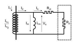
Fig. 2 : a CT equivalent circuit.
